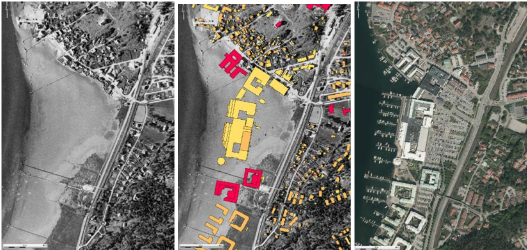
Från vänster: flygfoto över centrala Stenungsund från 1956, flygfoto från 1956 med dagens bebyggelse illustrerad – vilket visar hur mycket av centrala Stenungsund som står på utfylld mark, samt flygfoto från 2016.
