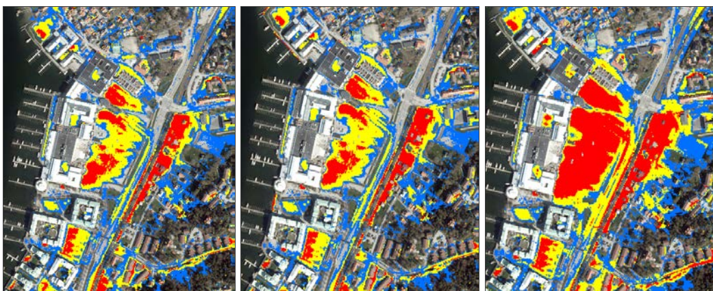
Kartbilder från översvämningsskarteringen. Från vänster: 100-årsregn, 100-årsregn med framtida höjd havsnivå, 500-årsregn. Färg och vattendjup: blått: 5-20 cm, gult: 20-50 cm, rött: >50 cm. Bilder: Ramböll.
