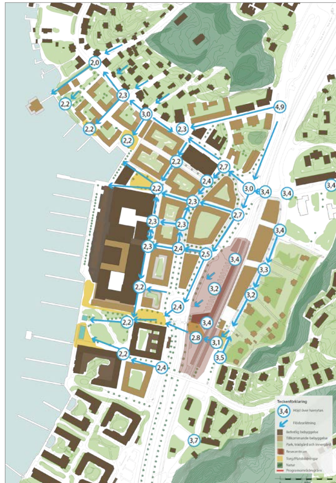
Karta som visar ett förslag på höjdsättning inom programområdet, för att vattnet vid ett skyfall ska kunna nå havet utan att översvämma. Siffrorna är angivna i meter över havet och är ungefärliga. Vid fortsatt detaljplaneläggning måste höjderna utredas och helheten inom programområdet beaktas.
